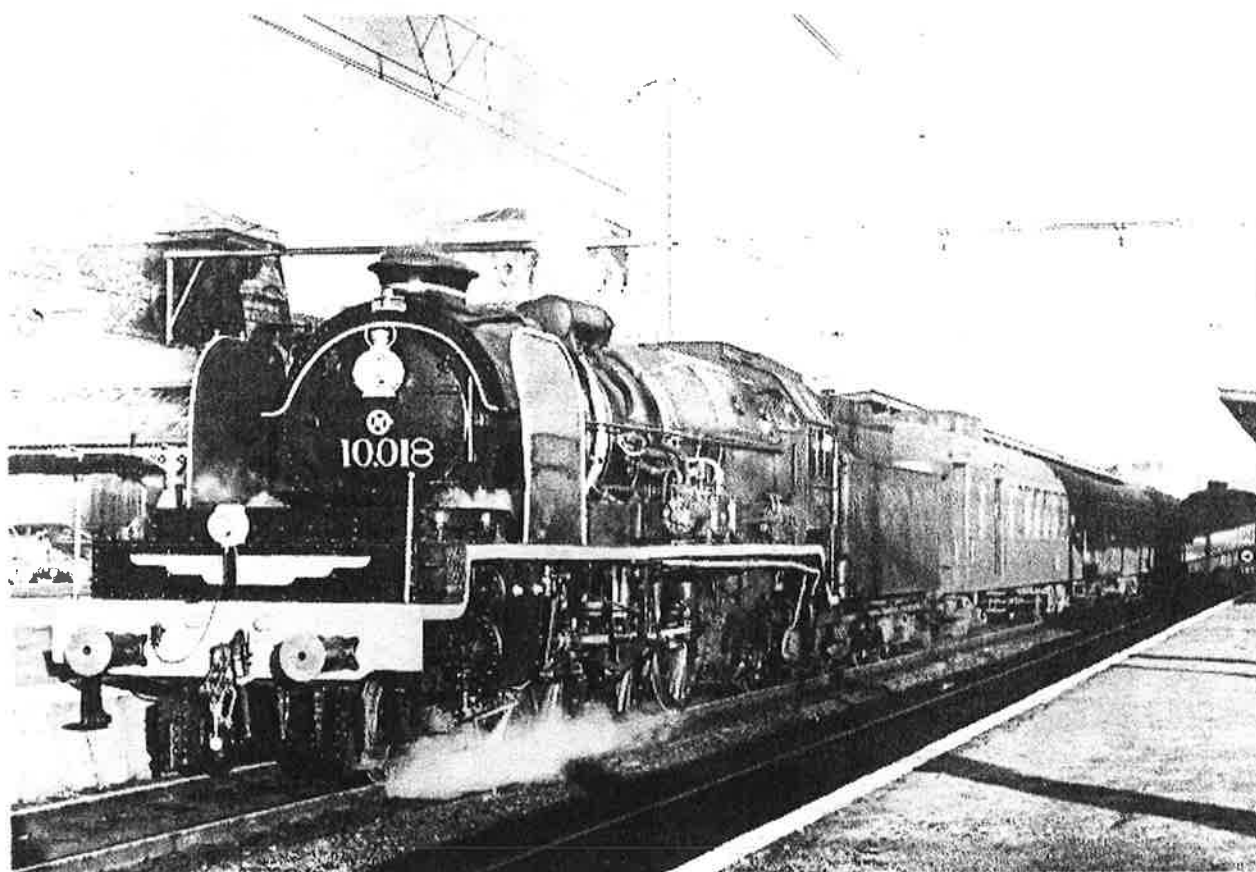
Au départ d'Arlon, la 10.018, "au timbre" (soupapes soulevées), purgeurs ouverts et souffleur en action (photo SNCB, collection Phil Dambly)
